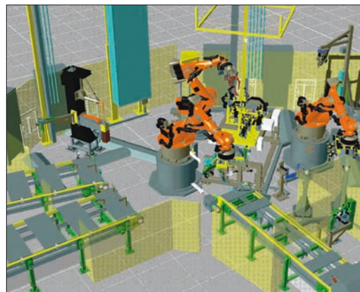
Obr. 4. Robcad – příklad modelu robotického pracoviště
