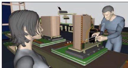
Obr. 3. Simulační nástroj Classic Jack s přesným digitálním modelem člověka
