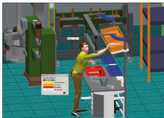
Obr. 2. Process Simulate Jack pro simulace a analýzy ručních operací
